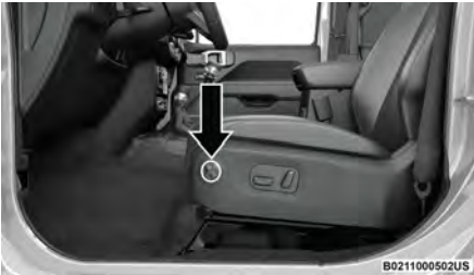
مفتاح دعامة أسفل الظهر العاملة بالطاقة
