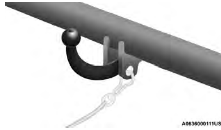
طريقة حلقة المشبك الكروي الثابت
