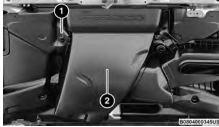
أول غرفة فصل مياه
