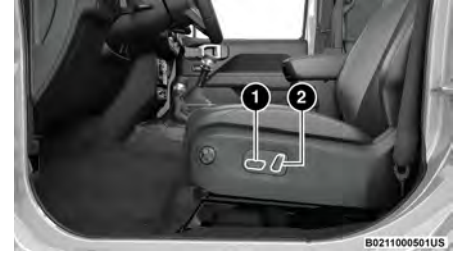
مفاتيح المقعد العامل بالطاقة
