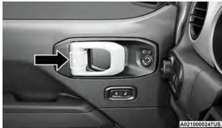
Manual Door Lock
